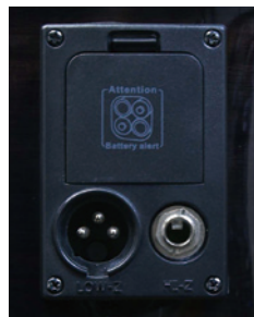
Output & Battery Box : ・Hi-Z Phone-type Output ・Low-Z XLR-type Output ・単3型乾電池 x4本使用
